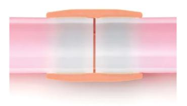
Elektroschweißmuffe FUSAPEX im Schnitt
