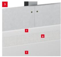
Systemaufbau der Beschichtung mit Spachteltechnik
