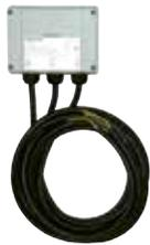
Anschluss-Set für den elektrischen Anschluss eines Kompakt-Durchlauferhitzers an eine Herdanschlussdose. Die integrierte Vorrangschaltung unterbricht kurzzeitig die Stromversorgung für den Elektroherd für die Zeit der Warmwasserzapfung.
