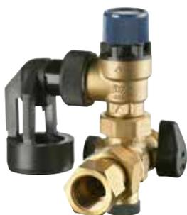
Sicherheitsgruppe für Aufputzmontage für geschlossene Wandspeicher und Druck-Kleinspeicher. Sicherheitsventil 0,6 MPa. Kugelabsperung, Speicheranschluss G 1/2, Manometeranschluss G 1/4 ohne Druckminderventil, Tropfwateranschluss G 1 aus Kunststoff, Messing-Gehäuse. Für waagerechte oder senkrechte Montage.
