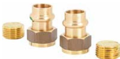
Das Montageset Aufputzinstallation für Durchlauferhitzer ermöglicht die Aufputzinstallation der Kalt- und Warmwasserleitungen für Durchlauferhitzer. Lieferumfang: je 2 Stück Stopfen G $\frac{1}{2}$ , Pressverschraubungen G $\frac{1}{2}$  x 15 mm sowie Dichtungen.
