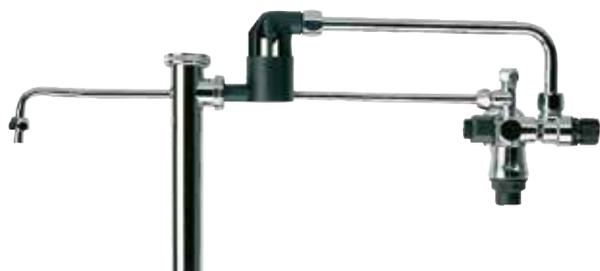
Sicherheitsgruppe SVMT für druckfeste Untertisch-Kleinspeicher mit 5 oder 10 Liter Inhalt. Druckbegrenzungsventil mit max. Eingangsdruck von 1,6 MPa (16 bar), Ausgangsdruck 0,3 MPa (3 bar) (Werkseinstellung). Mengenregelventil mit Manometeranschluss G 1/4, Ablauftrichter mit Rückstauverhinderer, Messing-Gehäuse, Chrom-Oberfläche.
