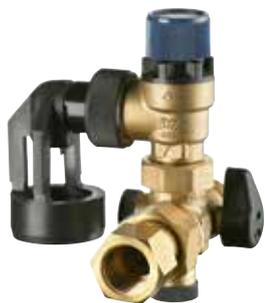
Sicherheitsgruppe für Aufputzmontage für geschlossene Wandspeicher und Druck-Kleinspeicher. Sicherheitsventil 0,6 MPa. Kugelabspernung, Speicheranschluss G 1/2, Manometeranschluss G 1/4 ohne Druckminderventil, Tropfwateranschluss G 1/4 aus Kunststoff, Messing-Gehäuse. Für waagerechte oder senkrechte Montage.
