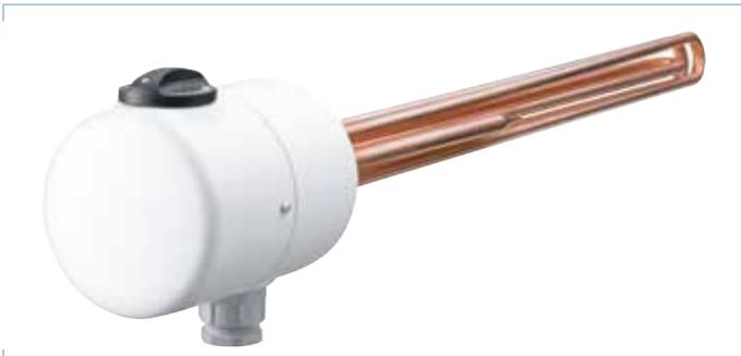
Einschraubheizkörper für geschlossene Heizungsanlagen und Trinkwasser-Erwärmungsanlagen. Stufenlose Temperatureinstellung von ca. 10°C bis 80°C. Temperaturbegrenzung auf 45/60/80 °C möglich. Eingebauter Temperaturregler mit Sicherheits-Temperaturbegrenzer. Werkstoff des Heizkörpers und Schutzrohres: Kupfer, Einschraubanschluss: Messing, Gewinde G 1 1/2 mit PT-FE-Dichtung.
