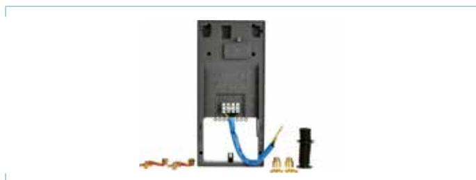
Rohrbausatz Versatzmontage inkl. Universal-Montagerahmen. Vertikale Verschiebung des Gerätes gegenüber dem Wasseranschluss um ca. 90 mm  $\pm$  10 mm nach unten. Der Universalrahmen schafft den erforderlichen Hohlraum hinter dem Gerät, um den Rohrbausatz aufzunehmen. Die Tiefe der Durchlauferhitzer erhöht sich um 30 mm. Lieferumfang: Universal-Montagerahmen, Befestigungsscheiben, Rohrbaugruppen, Hahnverlängerungen G $\frac{1}{2}$  und Dichtungen.
