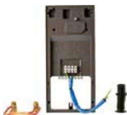
Rohrbausatz Gas-Wasserheizer-Austausch inkl. Universal-Montagerahmen. Zur Installation auf vorhandene Gas-Wasserheizer-Anschlüsse (KW links und WW rechts). Der Rohrbausatz verändert innerhalb des Gerätes die Wasseranschlüsse. Der Universalrahmen schafft den erforderlichen Hohlraum hinter dem Gerät, um den Rohrbausatz aufzunehmen. Die Tiefe der Durchlauferhitzer erhöht sich um 30 mm. Lieferumfang: Universal-Montagerahmen, Rohrbaugruppe G $\frac{1}{2}$  und Dichtungen.
