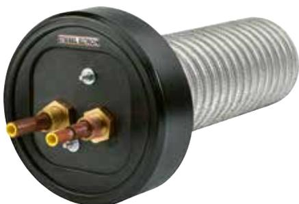
Sicherheits-Rippenrohr-Wärmeübertrager für die Warmwasserbereitung in Verbindung mit Kältemittelbetrieb. Der Wärmeübertrager ist mit einer Dichtung auf der Flanschplatte montiert und für den Einbau in Kombi-Standspeichern geeignet. Doppelwandiges Kupferrohr mit Leckanzeige und Schutzgasfüllung. Zum Lieferumfang gehören Schrauben und die Abdeckkappe mit Wärmedämmung.
