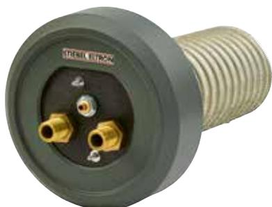
Rippenrohr-Wärmeübertrager für die Warmwasserbereitung in Verbindung mit Heizkesselbetrieb. Der Wärmeübertrager und das Thermostat-Schutzrohr sind mit einer Dichtung auf der Flanschplatte montiert und für den Einbau in Kombi-Standspeichern geeignet. Zum Lieferumfang gehören Schrauben, Isolierhülsen, Thermostat mit Schutzrohr (Durchmesser 6,5 mm, innen) für die Steuerung der Heizkreispumpe und die Abdeckkappe mit Wärmedämmung.
