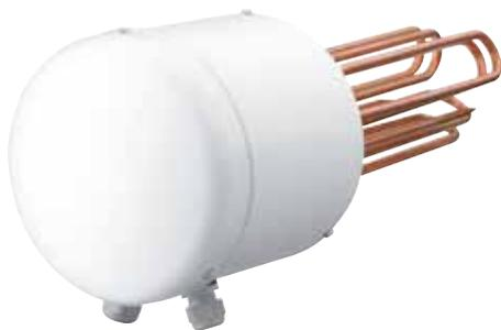
Heizflansche für den waagerechten Einbau in geschlossene Warmwasserspeicher mit Flanschstutzen nach DIN 4805, z. B. Gegenflansch GF 18. Hinweise der Speicher-Hersteller und DIN 4753 bzw. 4751 beachten. Lieferumfang: Temperaturregler mit Frostschutz-Stellung, Sicherheits-Temperaturbegrenzer, Flanschdichtung, Schutzhaube mit zwei Kabeldurchführungen.
