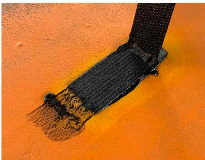
**Eine Haftzugprüfung in Form eines Abreißversuch durchgeführt**
