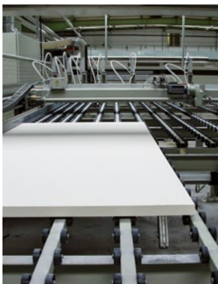
Plattenaufteilanlage für den Zuschnitt von Promat-Brandschutzbauplatten
