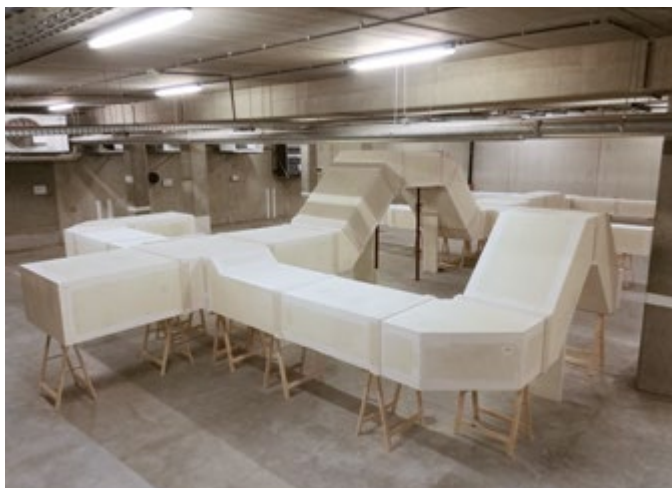
Messung von Druckverlusten an einem Promat-Leitungssystem
