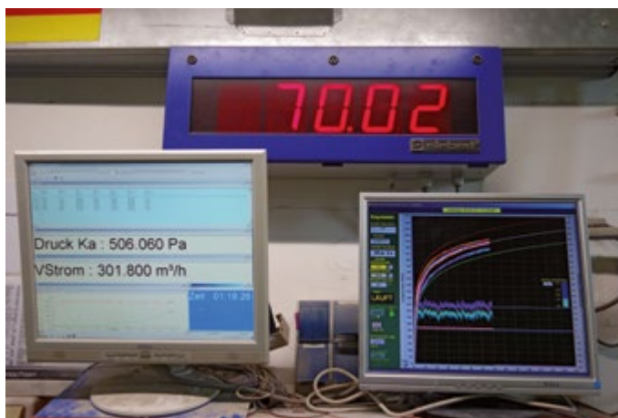
Steuerung Brandprüfung und Erfassung von Messdaten
