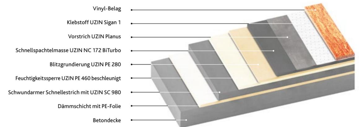
Die weiteren Systemkomponenten Grundierungen, Spachtelmassen und Klebstoffe sorgen dafür, dass der komplette Boden in 4 Tagen fertig ist.
