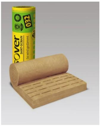
Mineralwolle-Dämmstoffe der Wärmeleitstufe 032 eröffnen jetzt neue Möglichkeiten für eine Dämmung von innen zwischen den Sparren. Da sich bei gleicher Dämmdicke die Dämmleistung erhöht, kann die geforderte Dämmwirkung mit deutlich schlankeren Konstruktionen erreicht werden. Das spart Kosten durch gesteigerte Energieeffizienz und durch den Gewinn von mehr Wohnfläche auf gleichem Grundriss.
