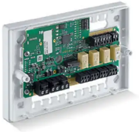
GCER 300 2-Tür Zutrittssteuerungssystem
