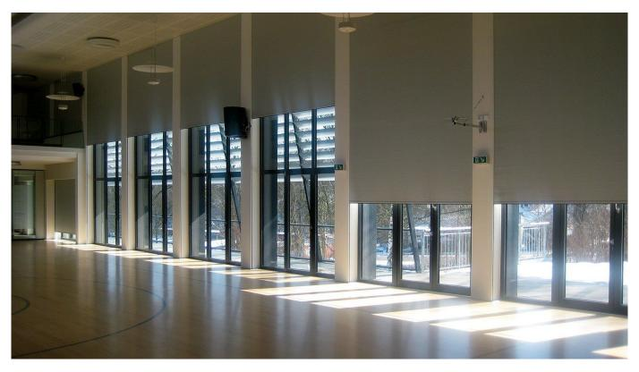
Zertifizierte ballwurfsichere Sonnenschuztzanlagen als Textile Blendschutz-, Wärmeschutz- und Verdunkelungssysteme in Sport- und Mehrzweckhallen gemäß DIN EN ISO 18032-3. Brichta bietet vier zertifizierte Montagesysteme für ballwurfsichere Anlagen, die neben dem Textilen Sonnenschutz auch als Raumteiler und Abtrennung in Vereins- und Schulsporthallen eingesetzt werden können.
