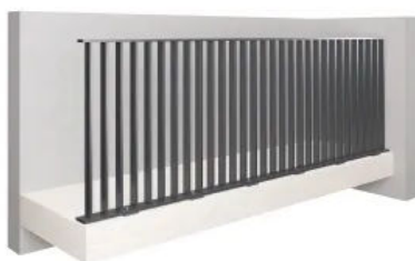
Montagebereich auf Bodenplatte
