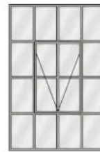
Senkklapp-Fenster nach aussen öffnend
