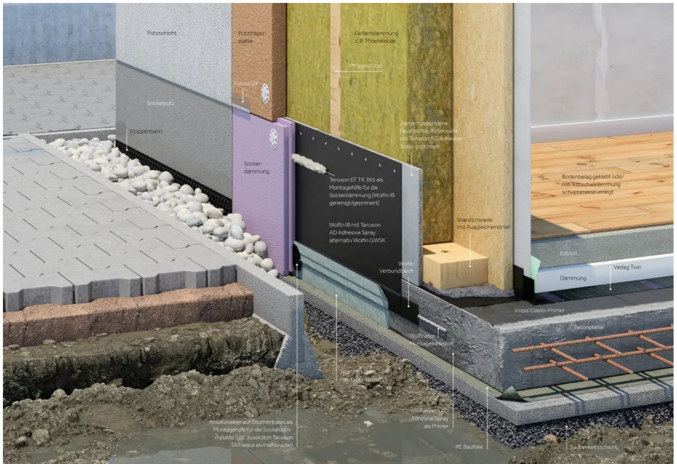
Variante 1 | Sockelabdichtung und Spritzwasserschutz im Holzbau
