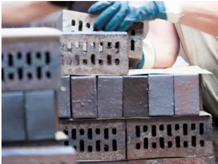
Wittmunder Klinker werden traditionell stranggepresst und handsortiert.
