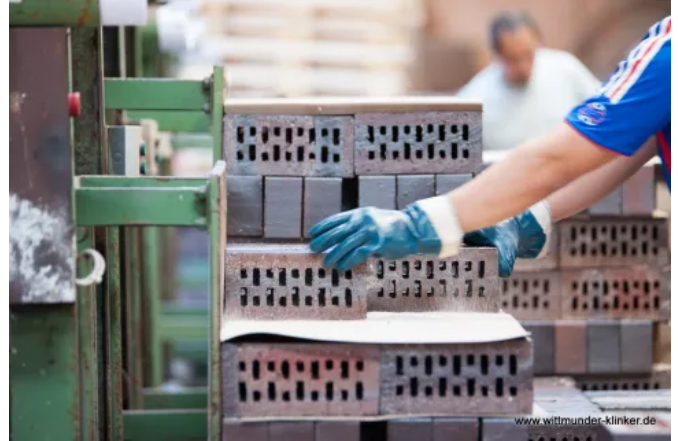
Nach dem Brennen erfolgt die Handsortierung.
