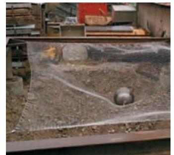
Testversuch zur Webnet Beanspruchbarkeit
