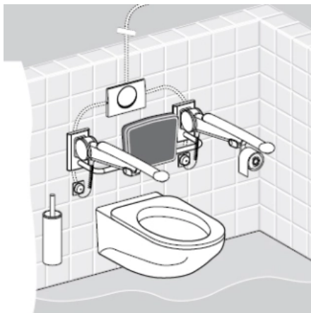
Geberit WC-Steuerung (Kabel/Netz): Spülauslösung durch Schließen des Stromkreises zwischen Taster am Stütz-Klappgriff und WC-Steuerung.
