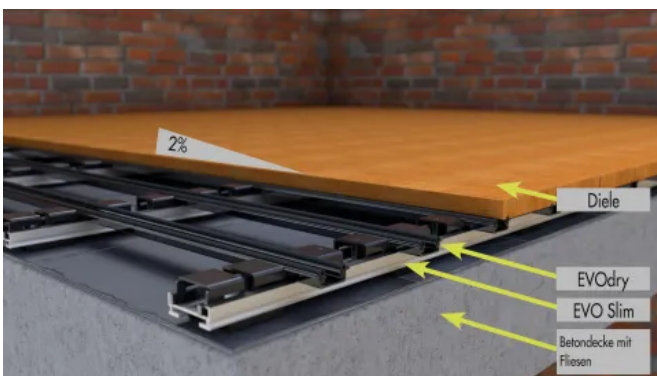
U2020 Profilsystem auf Betondecke
