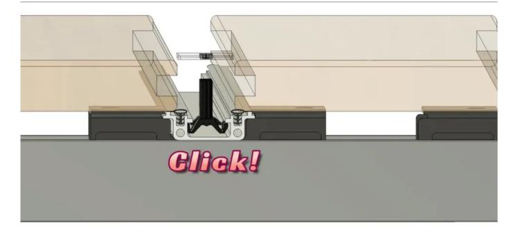
Montage ohne sichtbare Verschraubung
