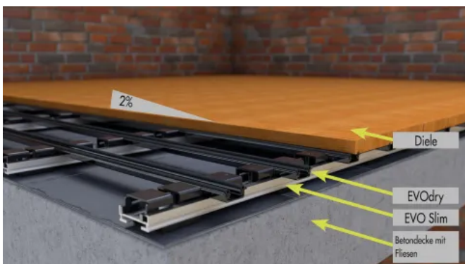
U2020 Profilsystem auf Betondecke
