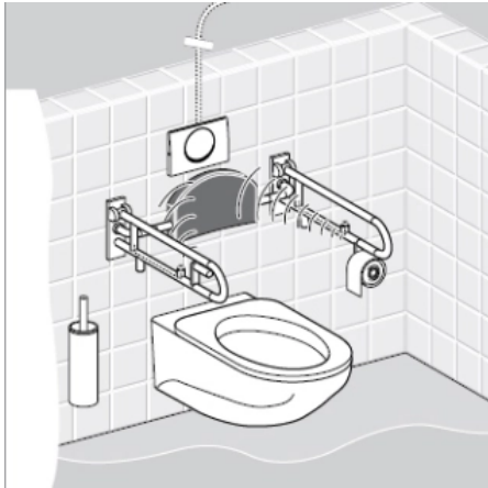
WC-Steuerung (Funk/Netz): Spülauslösung durch Aktivierung des Funksenders am Stütz-Klappgriff.
