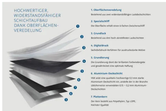
Hochwertiger, widerstandsfähiger Schichtaufbau dank Oberflächenveredelung
