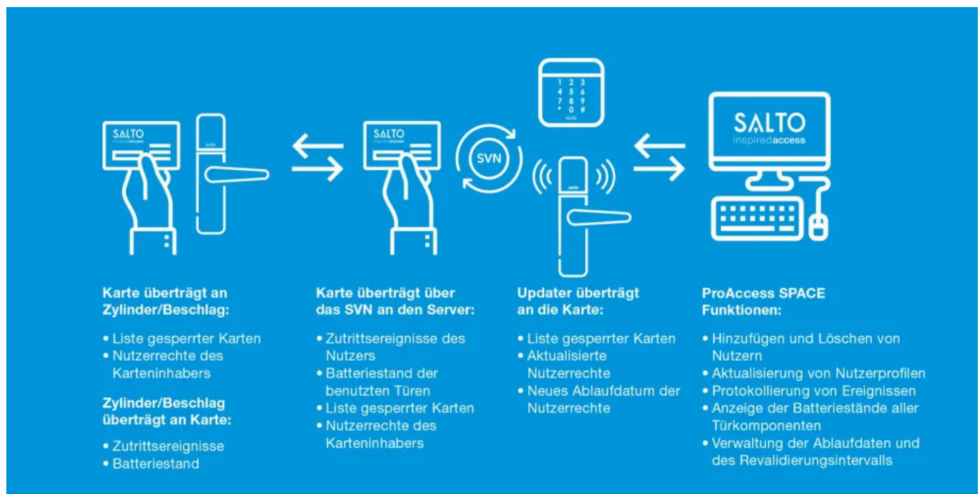
Funktionsweise des Salto Virtual Network (SVN)
