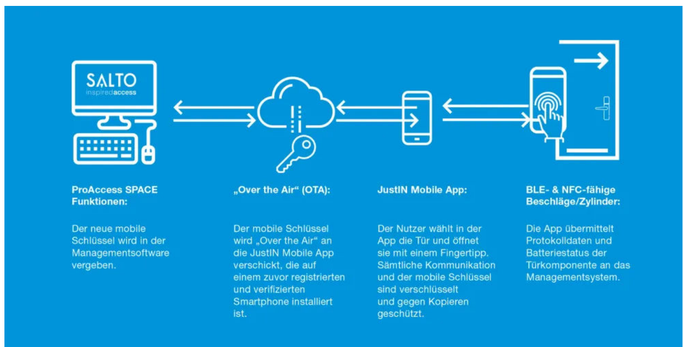
Funktionsweise der Smartphone-basierten Zutrittslösung JustIN Mobile
