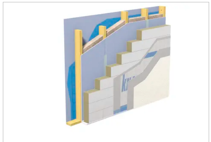
WARM-WAND Plus – Systemaufbau Holzbau
