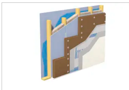
WARM-WAND Natur S – Systemaufbau im Holzbau mit Holzfaser-Dämmplatten STEICO protect H / M
