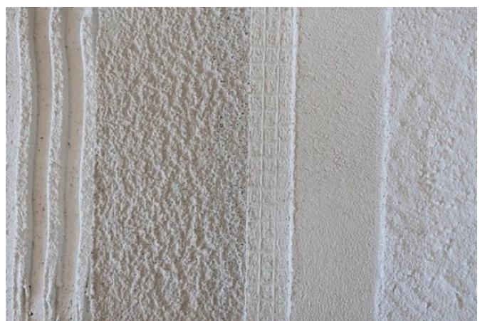
Jedes HASIT Wärmedämmputzsystem besteht aus wärmedämmendem Unterputz, einer Dämmputzschutzschicht und einem wasserabweisendem Oberputz. Diese Putzlagen sind in ihren Eigenschaften optimal aufeinander abgestimmt.
