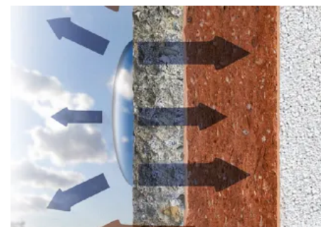
Bei POROTON®-WDF® kommt den Eigenschaften des Dickputzes der 15 mm dicke Ziegelsteig zugute. Die Trocknung der Fassadenoberfläche wird durch gute Wärmespeicherung begünstigt.
