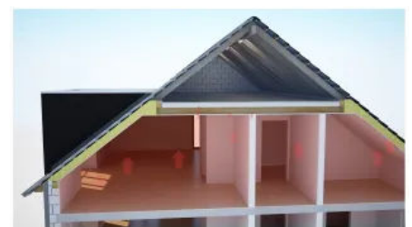
Heizwärmeverlust über ein ungedämmtes Dach
