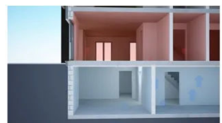
Heizwärmeverlust über eine ungedämmte Kellerdecke
