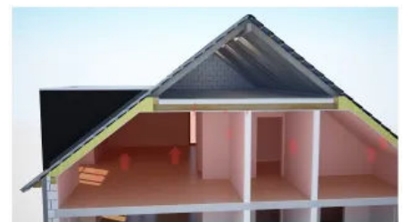
Heizwärmeverlust über ein ungedämmtes Dach
