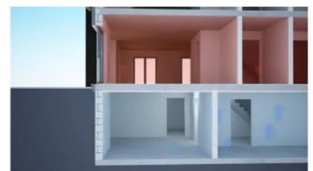
Heizwärmeverlust über eine ungedämmte Kellerdecke
