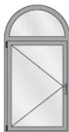
Einflügeliges Fenster mit Rundbogen-Oberlicht
