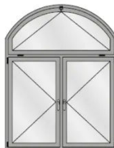
Zweiflügeliges Fenster mit Stichbogen-Oberlicht
