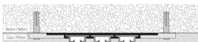
Unterputz-Profil HM-20613 | Befestigung an Betondecke mit Montageklipp
