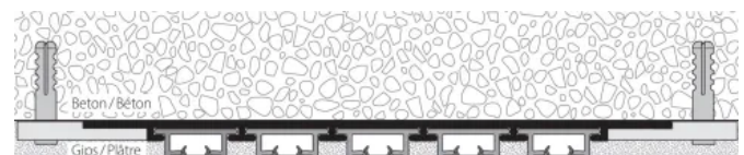
Unterputz-Profil HM-20625 | Befestigung an Betondecke mit Montageklipp
