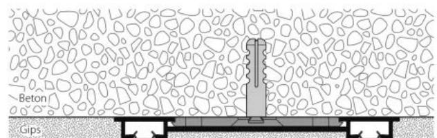
Unterputz-Profil HM-20105 | Befestigung an Betondecke
