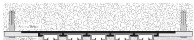
Unterputz-Profil HM-20625 | Befestigung an Betondecke mit Montageklipp
