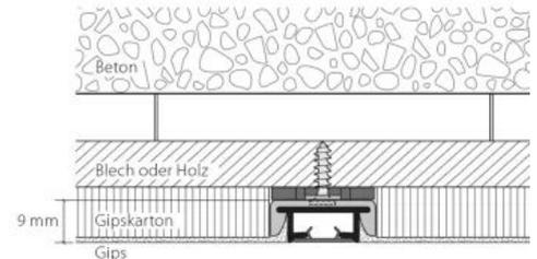
Unterputz-Profil HM-105 | eingeschraubt in GK-Unterkonstruktion mit eingelegtem Gips-Schutzband während des Verspachtelns
