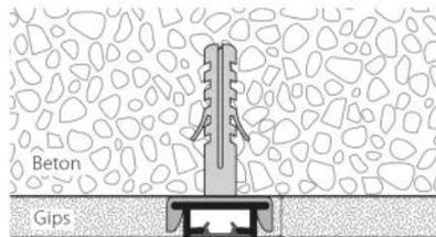
Unterputz-Profil HM-105 | an Betondecke befestigt mit eingelegtem Gips-Schutzband während des Verputzens
