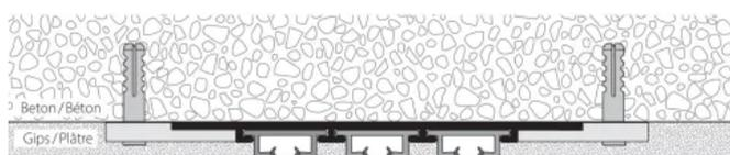
Unterputz-Profil HM-20613 | Befestigung an Betondecke mit Montageklipp
