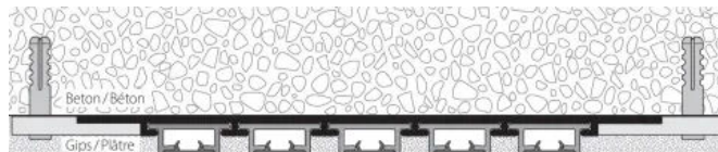
Unterputz-Profil HM-20625 | Befestigung an Betondecke mit Montageklipp
