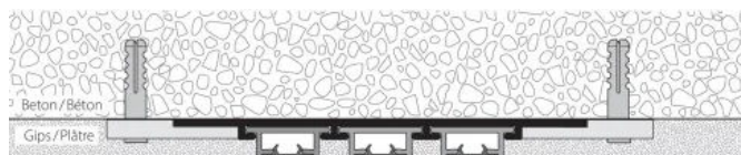
Unterputz-Profil HM-20613 | Befestigung an Betondecke mit Montageklipp
