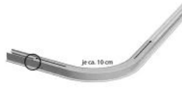
... wird auf Maß vorgefertigt, inkl. Rundungen. Schutzband wird eingelegt ...
