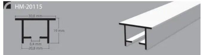
Vorhangprofil HM-20115 | für den Innenbereich mit Biegeradien ab 250 mm
