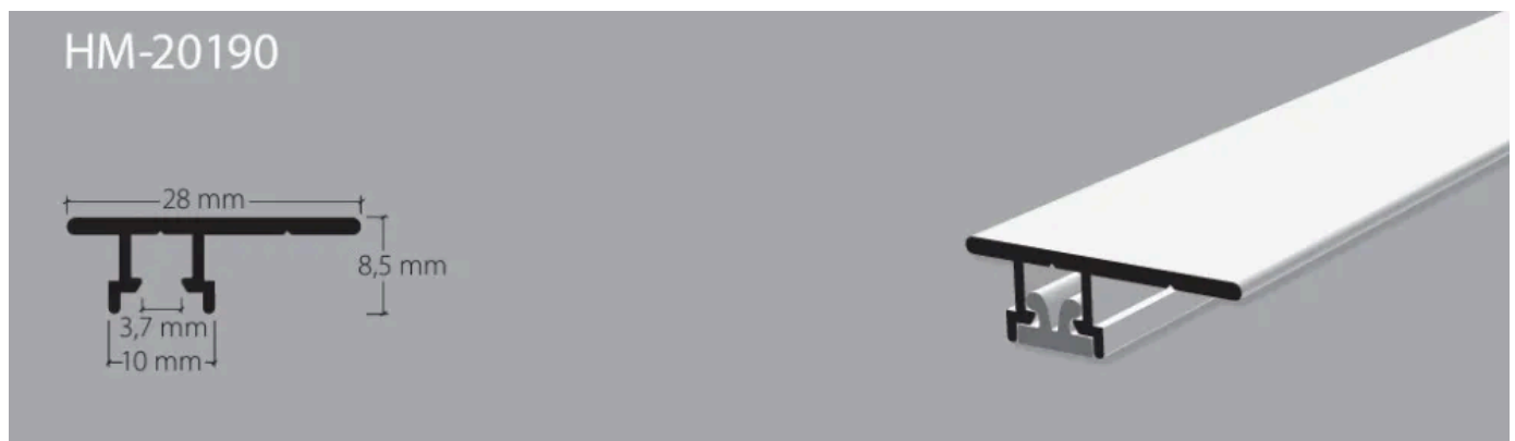
Profil HM-20190 | Bilder-Deckenprofil für die Unterputzmontage, haftgrundbehandelt, mit im Profil eingelegten Gips-Schutzband
