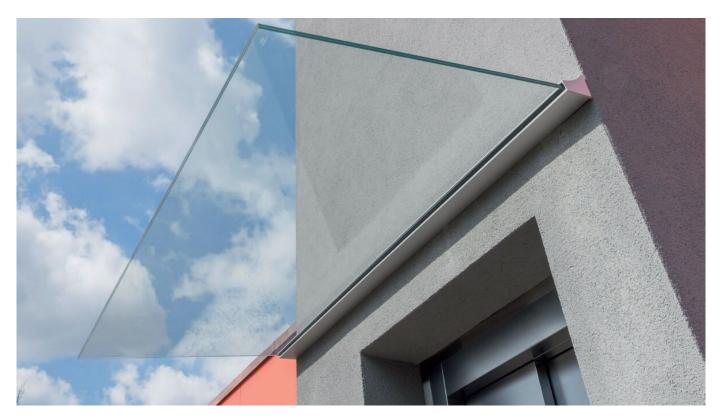
Das linear gelagerte Ganzglasvordachsysteme CANOPY cloud bietet maximale Transparenz und optische Leichtigkeit ohne funktionale Konstruktionen mit Stützen, Abspannungen und Wandkonsolen. Das System CANOPY classic mit Edelstahl-Punkthaltern erlaubt eine stufenlose Anpassung der Glasdachneigung zwischen 0 und 20°. Beide Systeme garantieren durch geprüfte Typenstatik, ETA und AbZ eine hohe Sicherheit.
