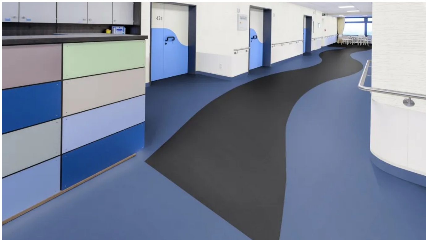
TARASAFE STANDARD, heterogener Bodenbelag mit hoher Rutschsicherheit in Kombination mit der Sparclean®-Oberflächenbehandlung
