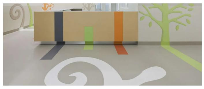
Heterogene Bodenbeläge mit eingearbeiteten mineralischen Kristallpartikeln für dauerhafte, erhöhte Rutschsicherheit.
