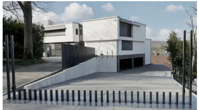
Private Zaun- und Toranlage mit versenkbaren Torpfosten bei abschüssigem Gelände.
