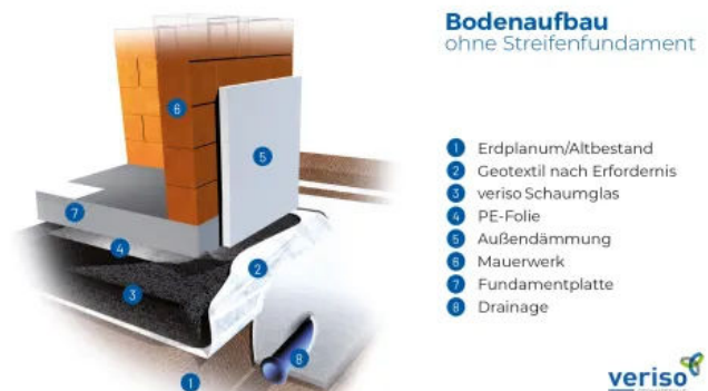
Systemskizze Bodenaufbau ohne Streifenfundament
