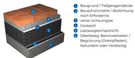
Systemskizze Belastbare Leichtschüttung
