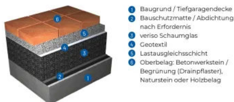
Systemskizze Belastbare Leichtschüttung
