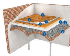
Systemskizze Sanierung Gewölbedämmung
