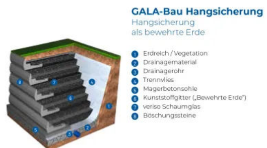
Systemskizze Hangsicherung
