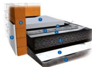
Systemskizze Fußbodenaufbau ohne Bodenplatte mit Estrich
