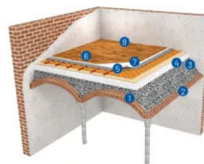
Systemskizze Sanierung Gewölbedämmung
