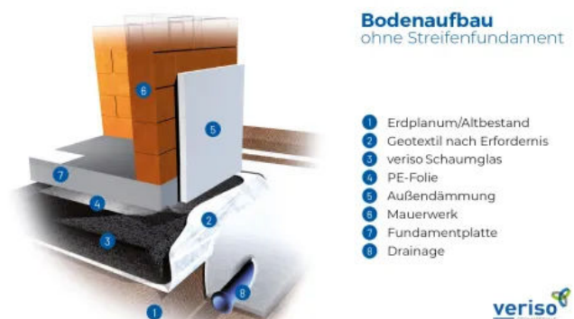
Systemskizze Bodenaufbau ohne Streifenfundament
