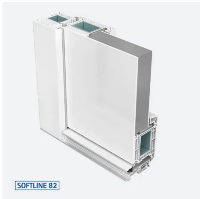
Haustürprofil SOFTLINE 82 mit thermisch optimierter Flügelgeometrie und Dämmwerte von bis zu U_d = 1,2 \text{ W}/(\text{m}^2\text{K})
