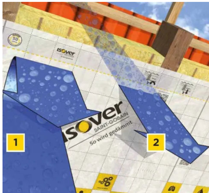
Die Funktion der Vario® Klimamembranen
