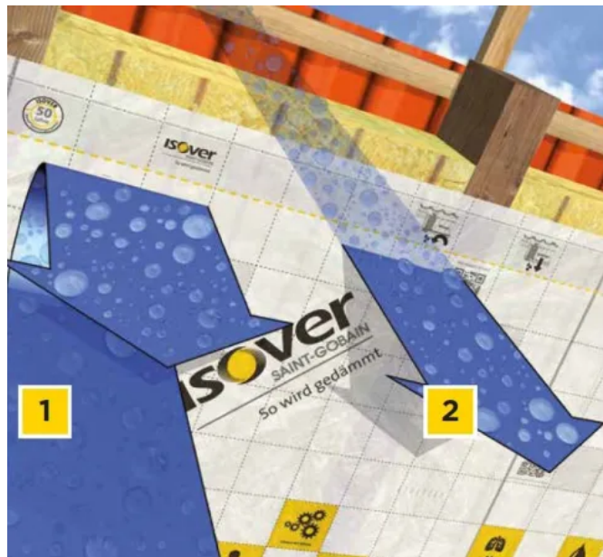
Die Funktion der Vario® Klimamembranen
