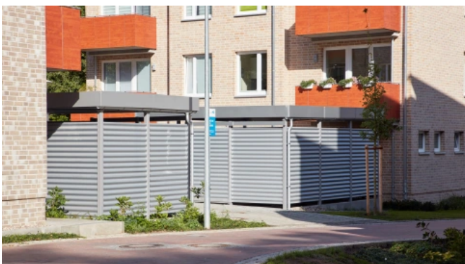
Fahrradhäuser - Trapezblechdach, Seitenverkleidung Stahlwellblech, Hängeschiebetor
