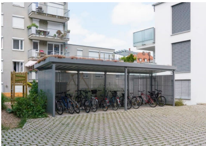
Fahrradüberdachung, Gründach light, Lochblech
