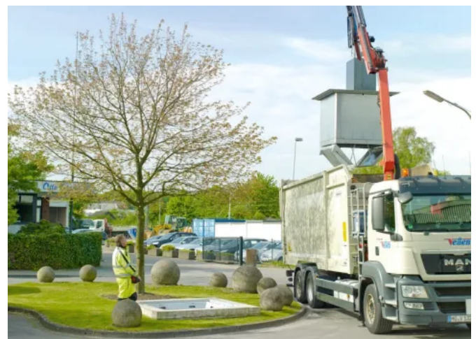
Effiziente Entleerung: Die Bodenklappen öffnen sich kontrolliert über das Aufnahmesystem.
