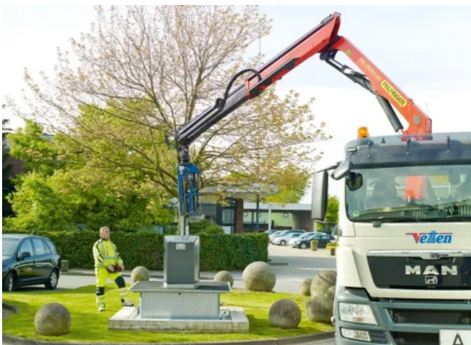
Sicheres Entleeren durch gleichmäßiges Anheben und automatischen Sicherheitsboden.
