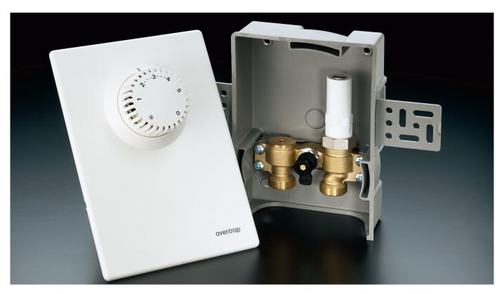
Die Oventrop Wandeinbausets "Unibox" ermöglichen die Einzelraum-Temperaturregelung mit Thermostatventil, die Temperaturbegrenzung von Heizflächen mit Rücklauftemperaturbegrenzer oder eine Kombination aus Beidem. Die "Unibox E BV" ist ein Hauptbestandteil der verteilerlose Flächenheizung und -kühlung "Unidis" mit dezentraler Vorlaufverteilung.
