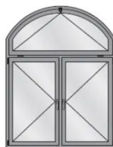
Zweiflügeliges Fenster mit Stichbogen-Oberlicht
