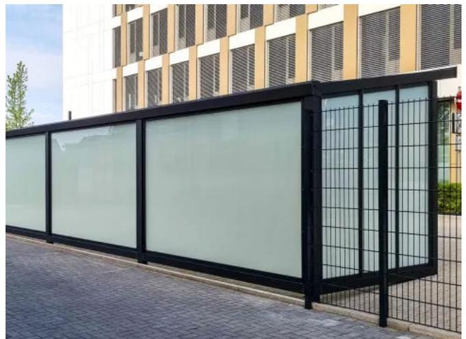
Die bis zu 7 x 5 m großen Pultdachcarport-Einzelmodule lassen sich in der Breite endlos koppeln.
