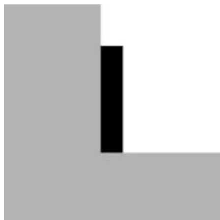
Sockelprofile aufgesetzt | Fußleisten aus Aluminium mit Clipsanker für die unsichtbare Befestigung auf die Wandfläche.
