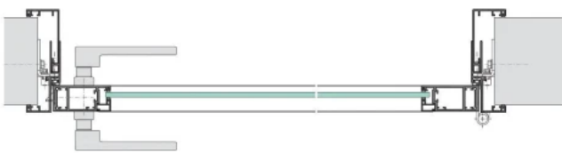
Aluminium-Rahmentür ART42, einflügelig, mit Umfassungszarge EUROKS48
