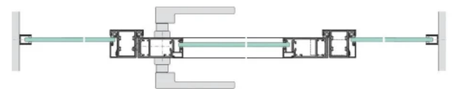
Aluminium-Rahmentür ART55, zweiflügelig, mit Zargenprofi | KLS46 mit Leibungsverkleidung, bandgegenseitig flächenbündig mit verdecktem Bandsystem
