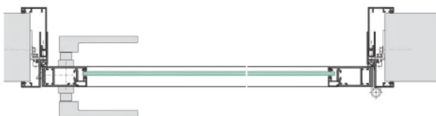
Aluminium-Rahmentür ART55, einflügelig, mit Blockzarge BS46 / KLS46 und separater Festverglasung
