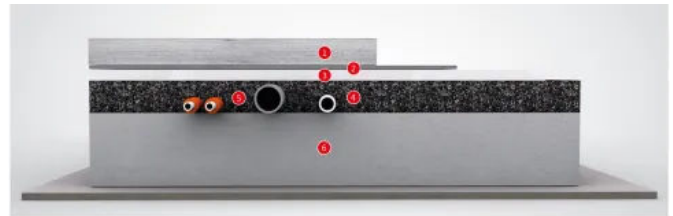
Vollflächiger Ausgleich von Installationen: Nass-Estrich auf unebener Bodenplatte
