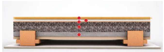
Schwimmender Trockenestrich auf Holzbalkendecke mit schwerer Auffüllung
