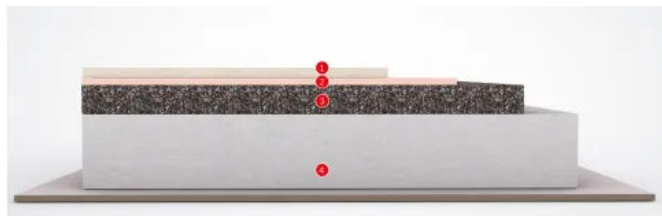
Trockenestrich auf unebener Bodenplatte (vollflächige Verarbeitung der Schüttung)
