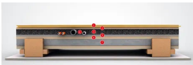
Vollflächiger Ausgleich von Installationen auf Holzbalkendecke
