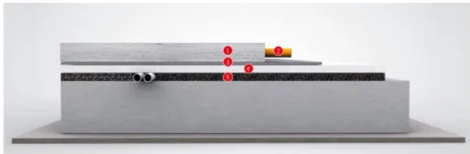
Nass-Estrich auf unebener Bodenplatte mit Fußbodenheizung
