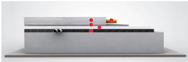
Nass-Estrich auf unebener Bodenplatte mit Fußbodenheizung
