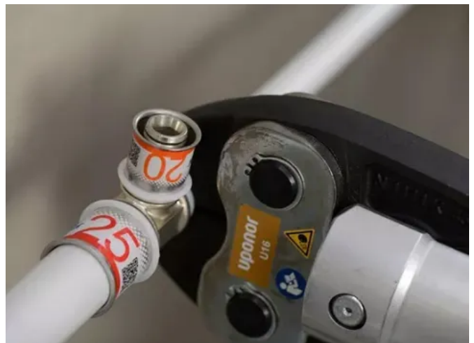
Schnell installiert in 3 Schritten: Rohr zurechtschneiden, Fitting einsetzen, Fitting pressen. Die sofortige Leckagenanzeige bei unkorrekter Verpressung vermeidet Installationsschäden.
