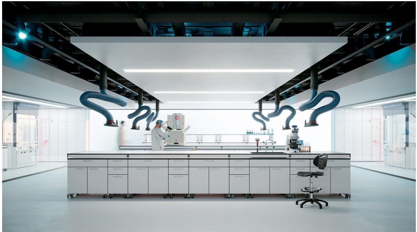
Die kompakten Hochdruck-Schichtpressstoffplatten (HPL, High-Pressure Laminat) Trespa® Toplab®, hergestellt aus natürlichen Fasern und thermogehärteten Harzen, verlängern die Lebenszeit von Laborarbeitsplatten und -regalen erheblich .
